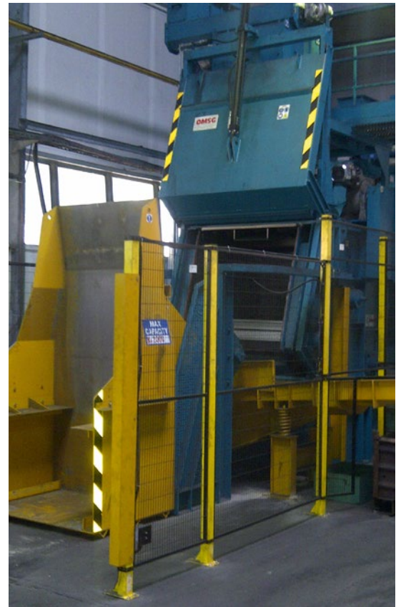
Urządzenie SG6 H2 wyposażone zostało w specjalną taśmę nieckową pozwalającą na oczyszczanie nawet bardzo drobnych i ostrych detali.
