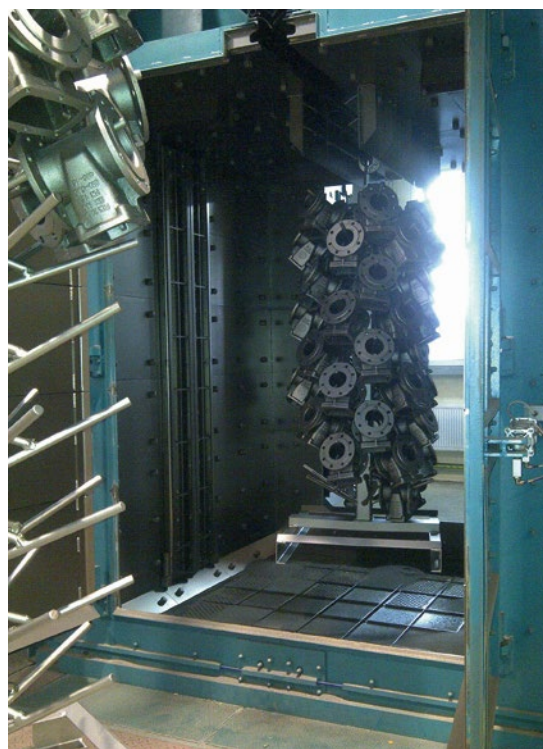
Urządzenia z serii SANDERMATIC 15 NA LF, które wyposażone jest w specjalne turbiny typu LONG LIFE.
