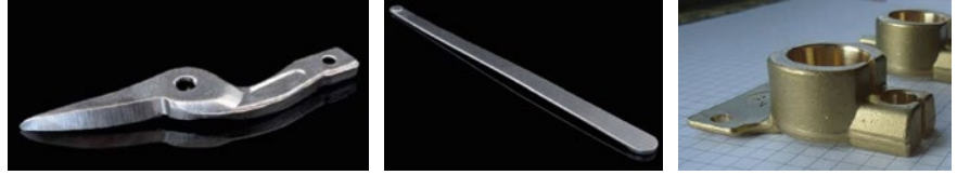
Przykładowe detale, które są niszczone w przypadku klasycznych konstrukcji przekroju przenośnika nieckowego i mogą być oczyszczane tylko w przypadku zainstalowania specjalnego przenośnika OMSG w maszynach z taśmą stalową.
